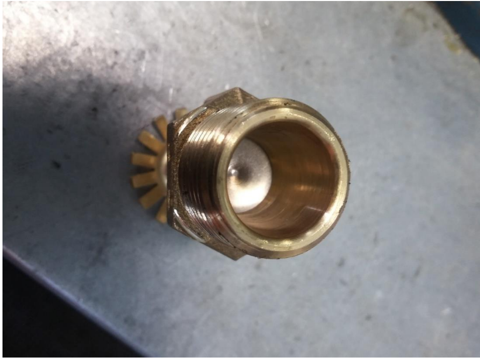
Фото 3. – Наличие следов от муфты на оросителе.
