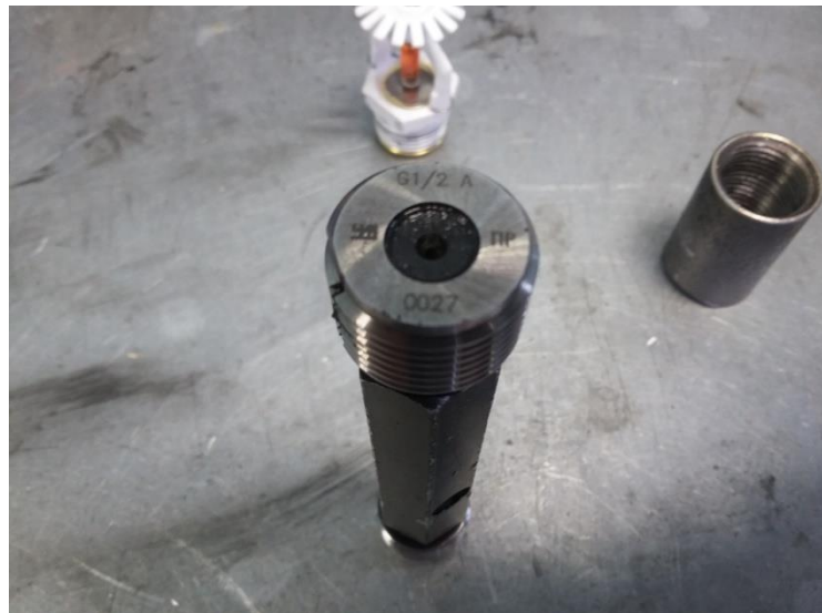
Фото 4 Пробка для контроля резьбы муфты
