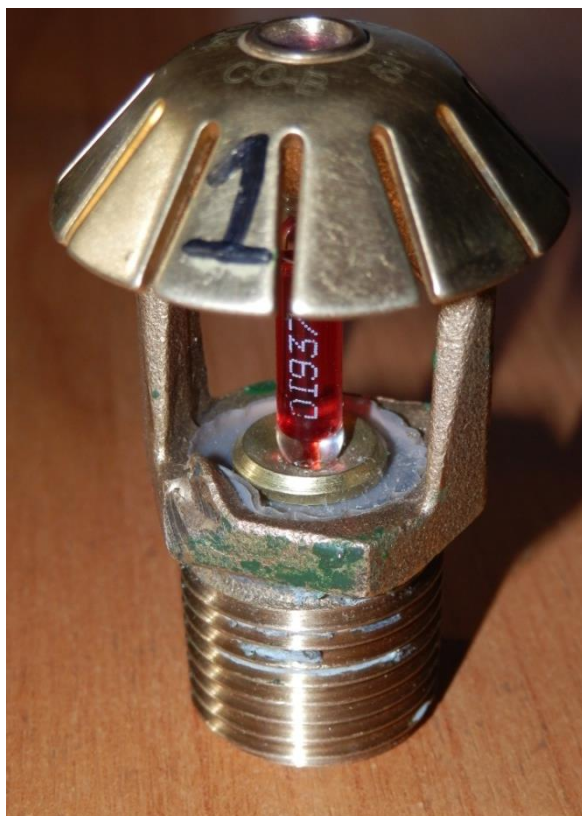
Фото 8 - Примеры замятия фланца оросителя (поверхность под ключ).
