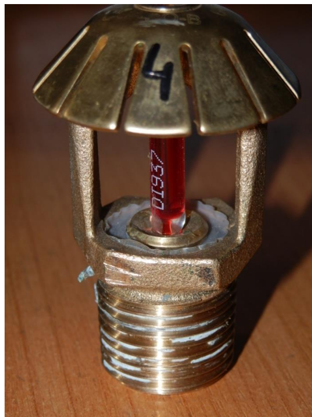
Фото 8 - Примеры замятия фланца оросителя (поверхность под ключ).
