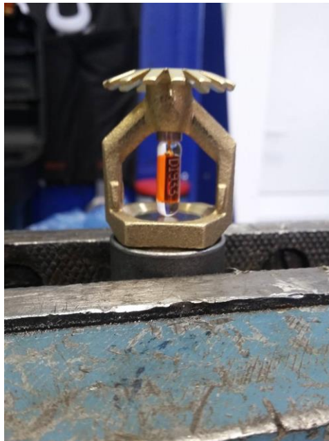
Фото 2 – Ороситель закрученный от руки в муфту с прослабленной резьбой.
