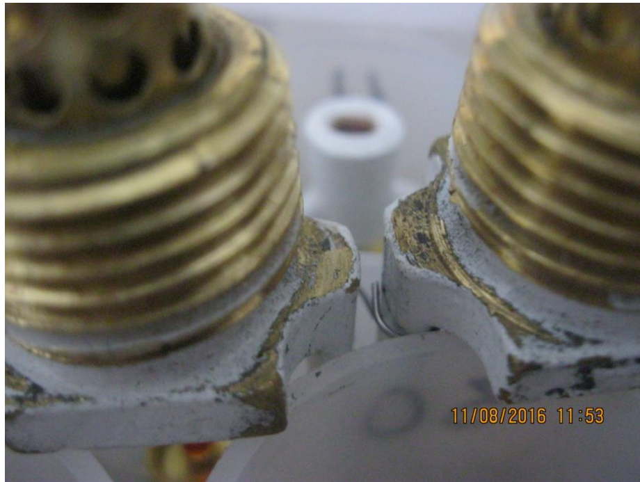
Фото 6 Пример повреждений фланца оросителя со стороны резьбы
