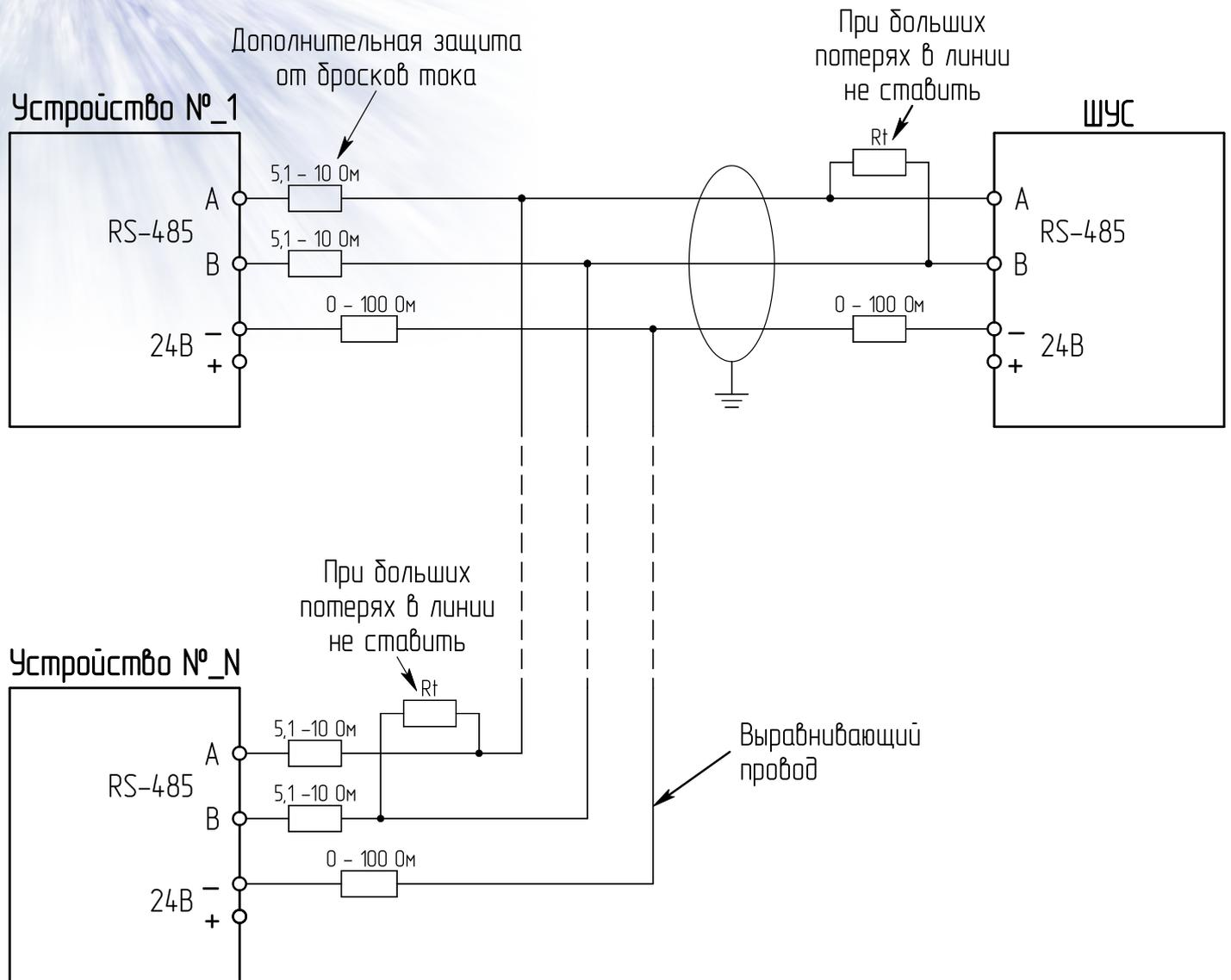
Для стабильной работы приборов в сети RS-485, необходимо наличие третьего (выравнивающего) провода, соединяющего «нули» приборов (обычно это минус питания прибора или специальная клемма).
