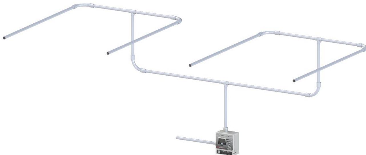
Рисунок 5 – Воздухозаборный трубопровод с 4 симметричными ветвями
