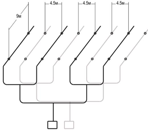
Рисунок В.4 Пример конфигурации трубопровода ИПА для алгоритма С
