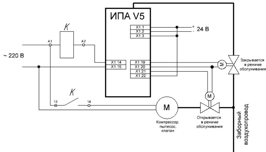
Рисунок 8 – Схема подключения ИПА с управлением кранами. Вариант 3.
