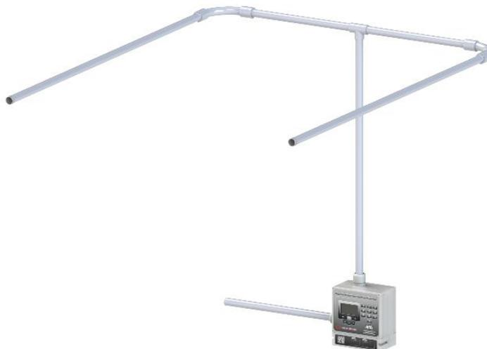
Рисунок 4 – Воздухозаборный трубопровод с 2 симметричными ветвями
