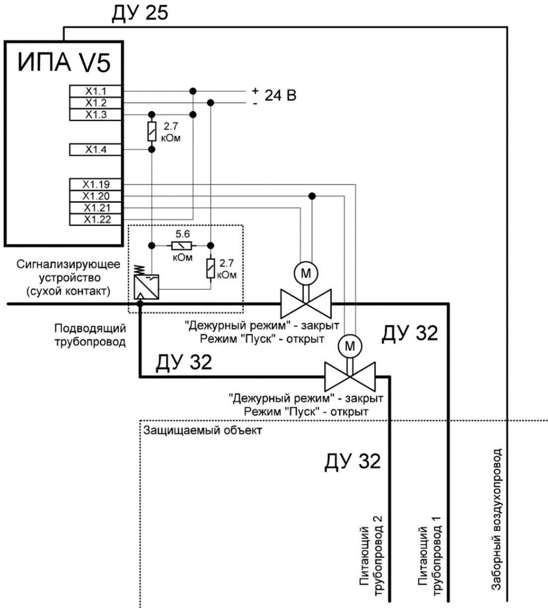
Рисунок 7 – Схема подключения ИПА с управлением кранами. Вариант 2.
