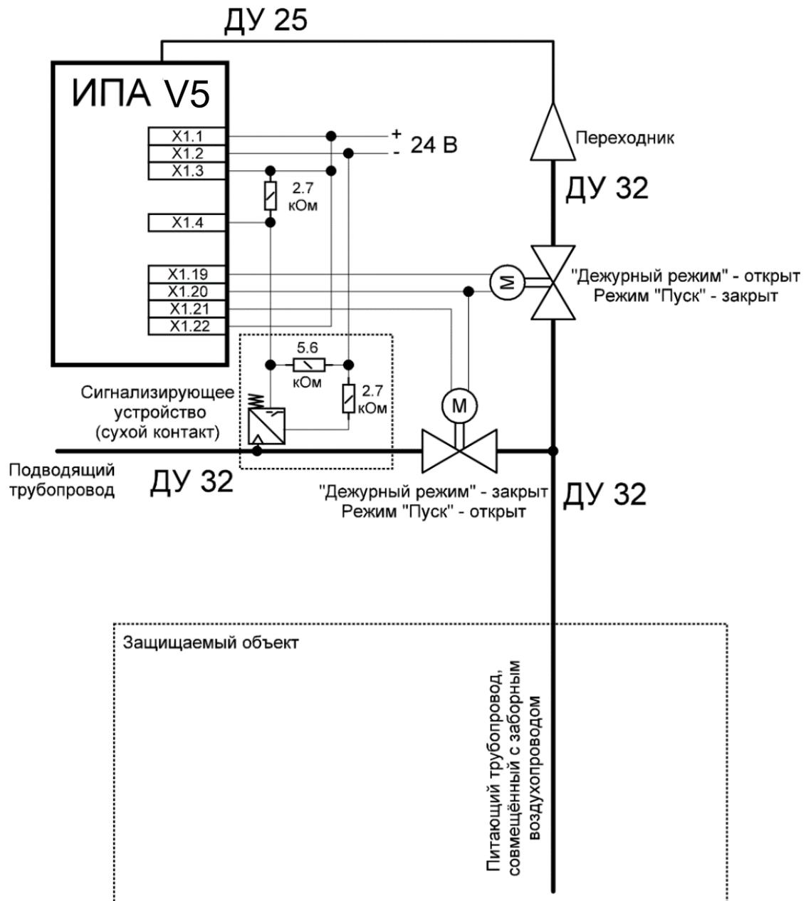
Рисунок 6 – Схема подключения ИПА с управлением кранами. Вариант 1.
