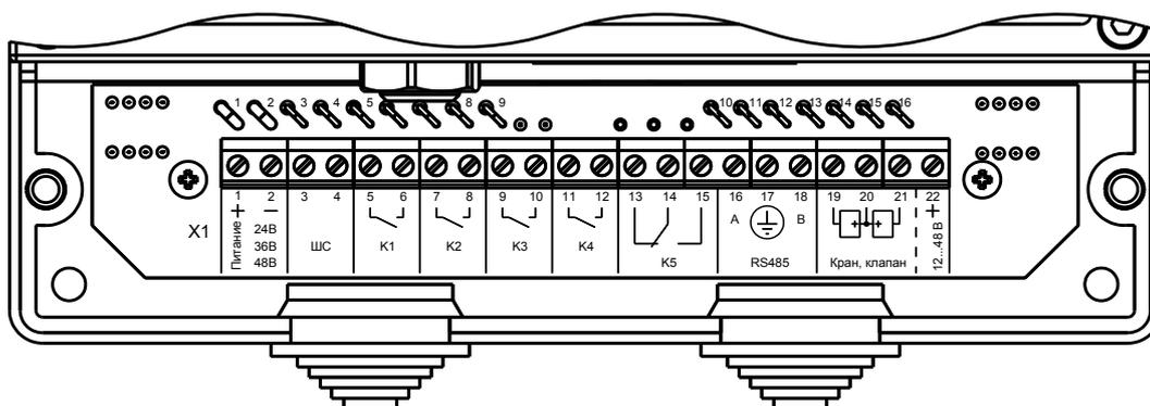
Рисунок 13 – Клеммы извещателя
