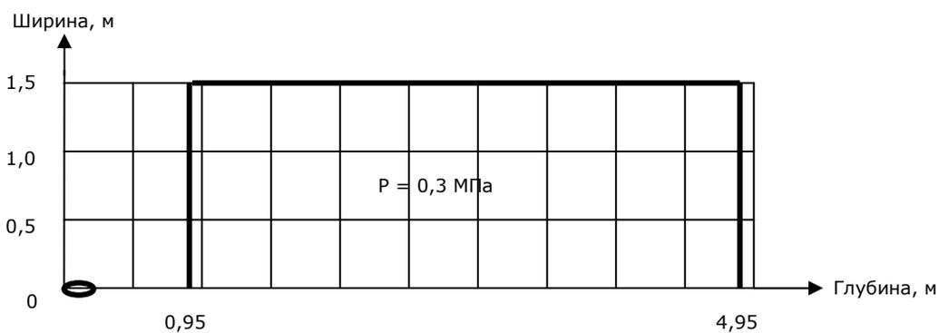
**Значения среднего удельного расхода на 1 метр ширины завесы оросителей «СВГ-10» и «ДВГ-10» при установке вертикально вниз**
