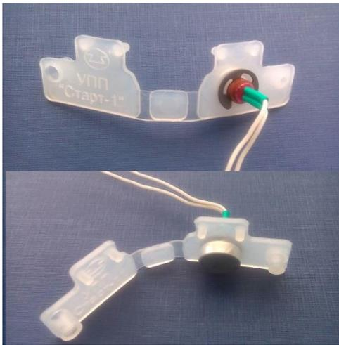
УПП «Старт-1» монтируется на оросителе, обеспечивает принудительный пуск оросителя путем подачи внешнего сигнала на выходы встроенного электрически управляемого пиротехнического привода.
